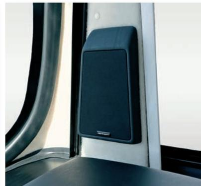
Mittelton-Modul A-Säule - (Abb. mit Abdeckung)
