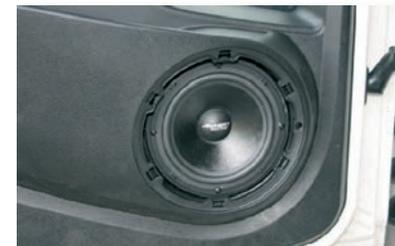
Tieftöner »XM165« im werkseitigen Einbauort der Fahrzeigtüre
