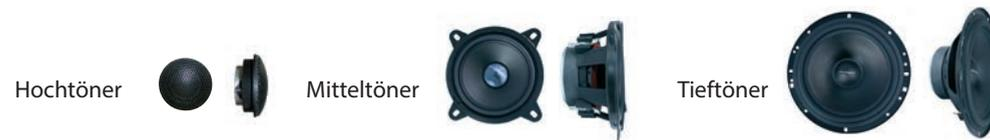
Hohe Töne haben eine hohe Frequenz, also eine Schallwelle, die sehr schnell schwingt. Aus diesem Grund sind hier kleine Membrane von Vorteil. Diese können schnelle Schwingungen präzise und klar weitergeben. Mitteltöner sind für den mittleren Frequenzbereich optimiert. Die Wiedergabe von Sprache und vieler Instrumente hängt entscheidend von diesem Bereich ab. Tiefe Frequenzen benötigen lange Schallwellen, die mit einer großen Membrane und einem großen Gehäuse optimal wiedergegeben werden können.
