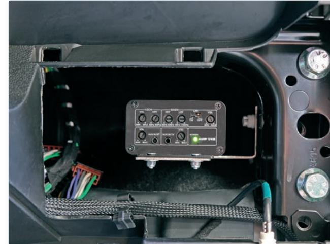
*Verstärker mit Montagewinkel am Einbauort*
