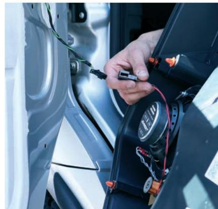
plug&play-Anschlusskabel werden bei der Montage im Handumdrehen zusammengefügt
