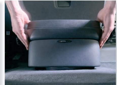
Durch den Anschluss des »plug & play«-Kabels kann der Subwoofer einfach mit dem Verstärker verbunden werden und anschließend unterhalb der Mittelkonsole eingebaut werden.
