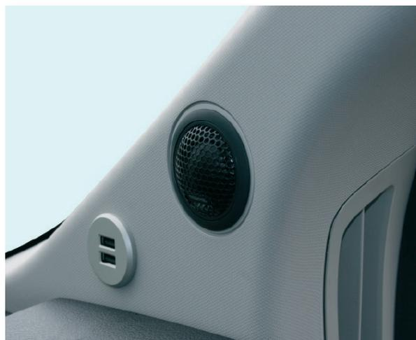
Hochtöner im werkseitigen Einbauort montiert
