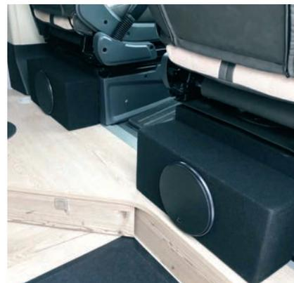
Magnetic Subwoofer an der Rückseite des Fahrer- und Beifahrersitzes befestigt.
