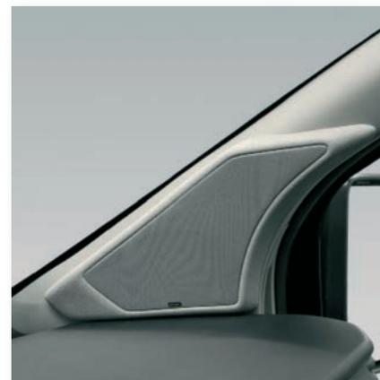
Mittelhochton-Modul an der A-Säule montiert ab Bj.18
