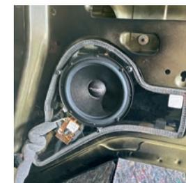
165mm Tieftöner in der Seitenverkleidung (Einbausituation)
