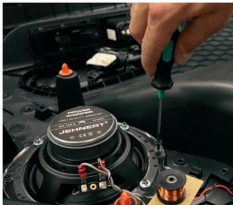
Tieftöner wird mit Montagering auf der Fahrertüre installiert
